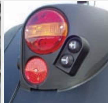
Comando esterno distributore idraulico
