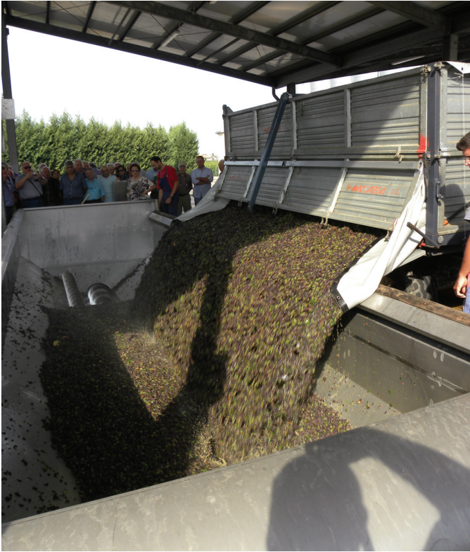
>> Scarico in cantina con un classico carro aziendale dotato di telo, una scelta resa obsoleta dalle nuove vasche raccolta ermetiche, maneggevoli e anche, volendo, refrigerate.
