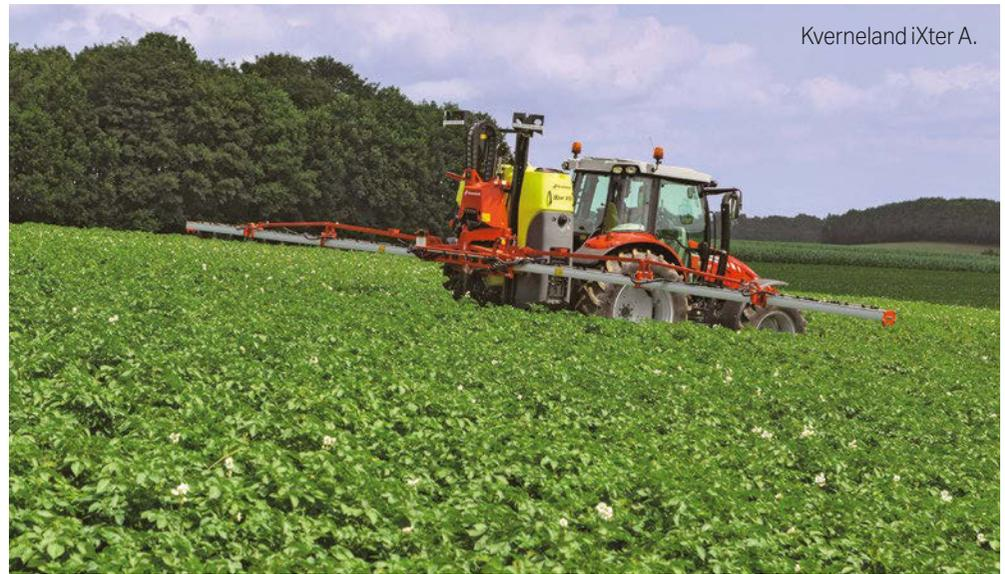
assicurare un lavoro di qualità) e chiusura automatica, sezione per sezione, via Gps (viene così molto limitata la sovrapposizione tra i passaggi, per un maggiore risparmio di prodotti fitosanitari e allo stesso modo, grazie alla gestione automatica dell'apertura/chiusura degli ugelli, il comfort dell'operatore è notevolmente migliorato).
