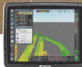
YieldTrakk è il sistema integrato Topcon AG per la mappatura di tutte le colture trebbiate. I monitor X35 e X25, già utilizzati per la guida delle trattrici aziendali e della mietitrebbia, vengono collegati a collaudati sensori di flusso e di umidità o interfacciati con quelli forniti di serie sulla mietitrebbia.
