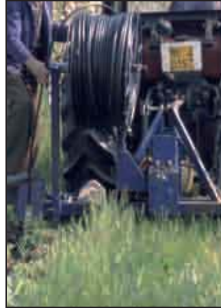
[ Interramento di ala gocciolante.
