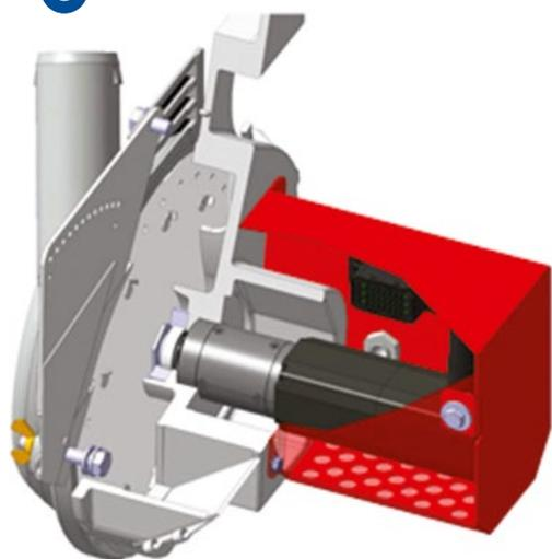
Organo di semina azionato da motore *Brushless* (Maschio-Gaspardo). L'impiego di motori elettrici in sostituzione di dispositivi meccanici o idraulici apre ad interessanti sviluppi. Questi dispositivi, di basso costo e bassa manutenzione, grazie alla loro reattività e alla loro più facile gestione consentono la variazione del rateo in tempo reale e quindi una maggiore precisione.
