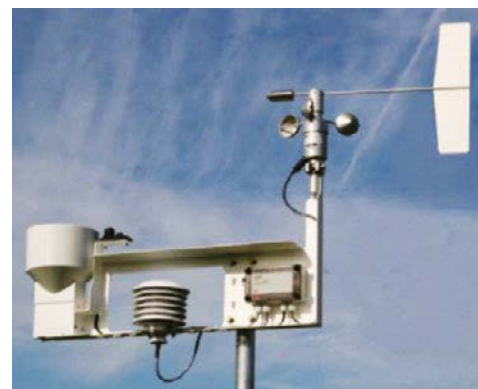
4 - Data logger collegabile fino a 7 sensori (Delta-T, Lombard & Marozzini)
