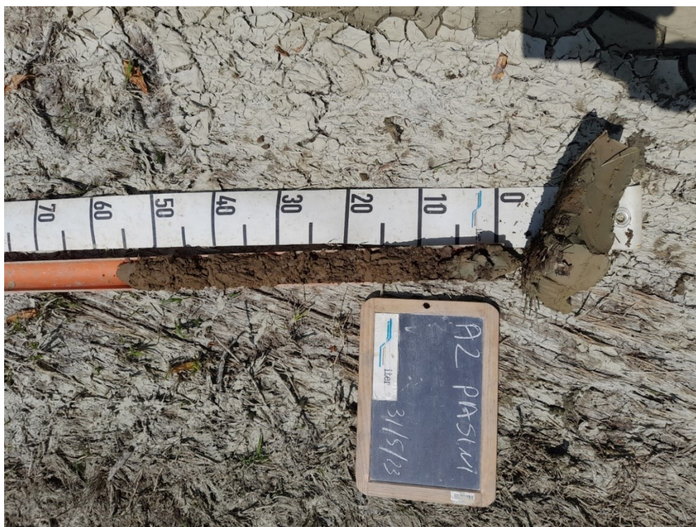
Trivellata eseguita sotto fango morbido spesso circa 8 cm. Strato lavorato umido.
