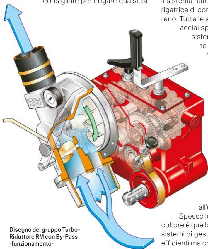
Disegno del gruppo Turbo-Riduttore RM con By-Pass -funzionamento-
